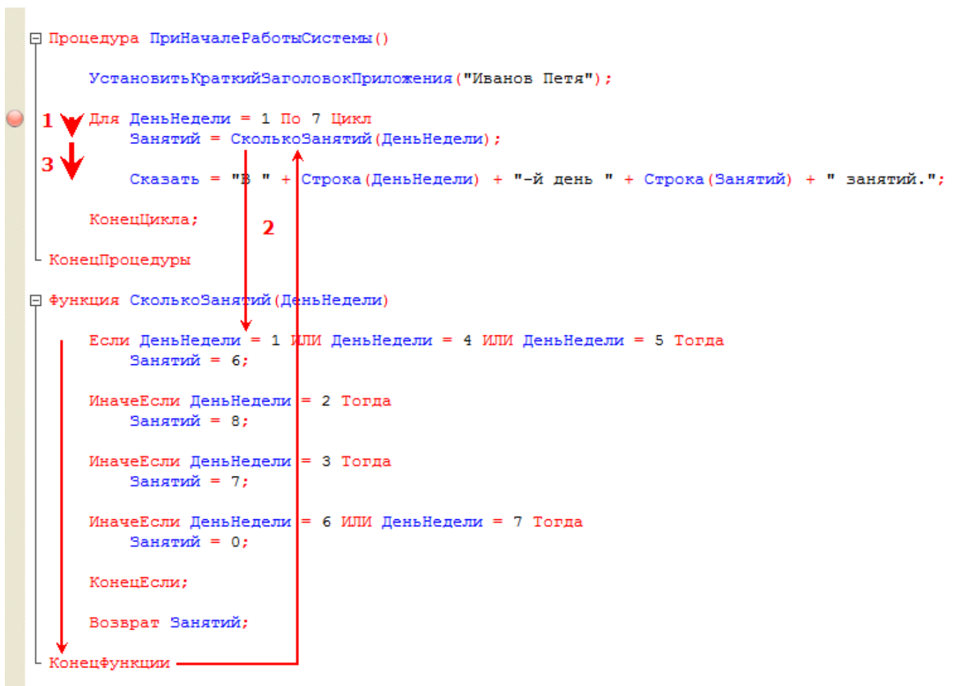
Рис. 3.156. Последовательность исполнения при вызове функции
