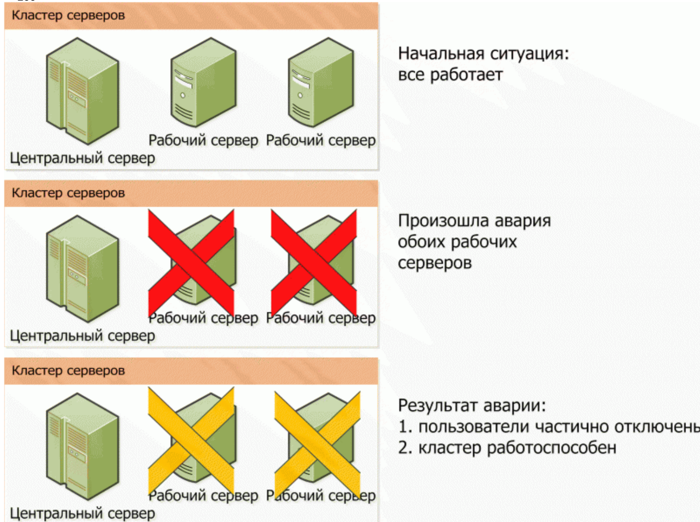
Рис. 9. Аварийное завершение двух рабочих серверов
