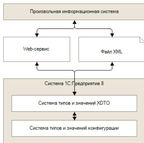
Рис. 331. Общая схема XDTO
