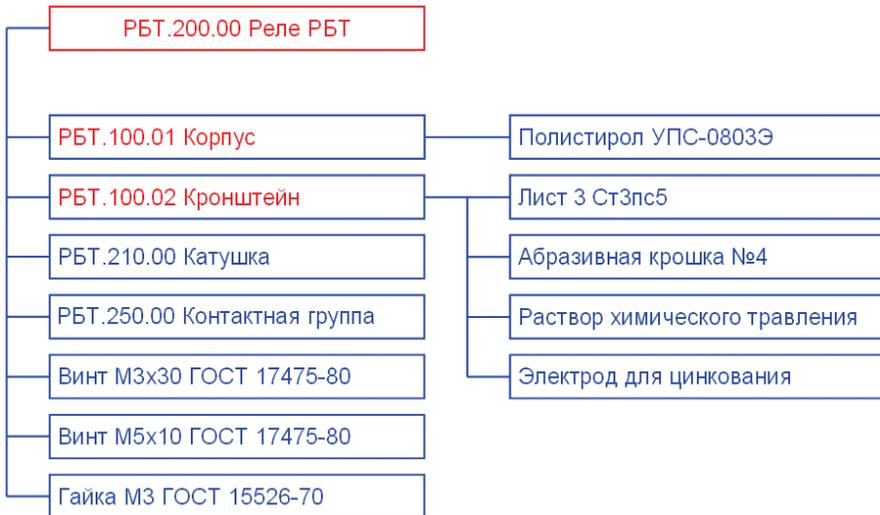
**Рис. 2.4.** Структура изделия продукции «РБТ.200.00 Реле РБТ»
