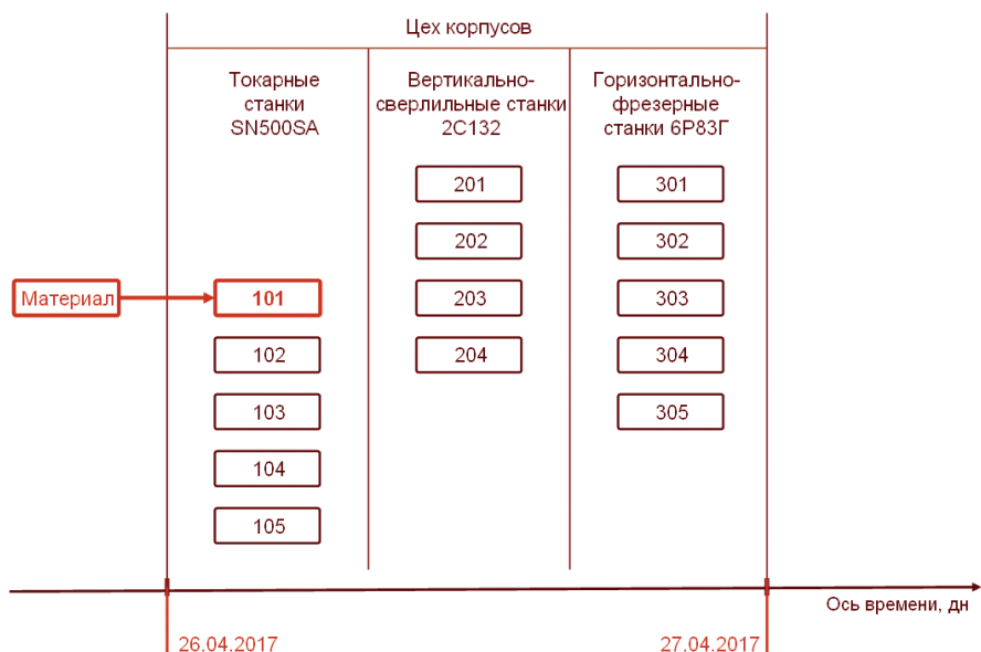
Рис. 5.19. Движение обрабатываемой партии полуфабрикатов на момент выполнения токарной операции
