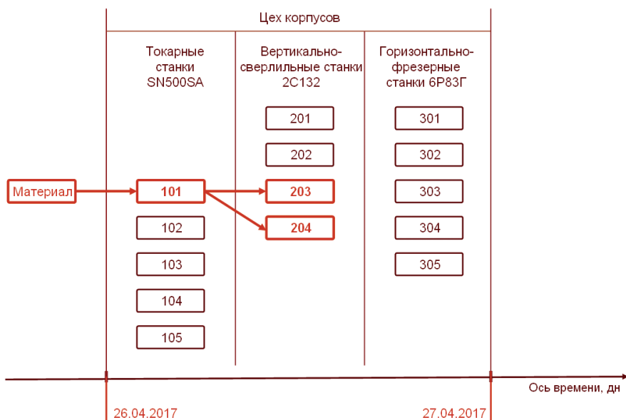
Рис. 5.21. Движение обрабатываемой партии полуфабрикатов на момент выполнения операции сверления
