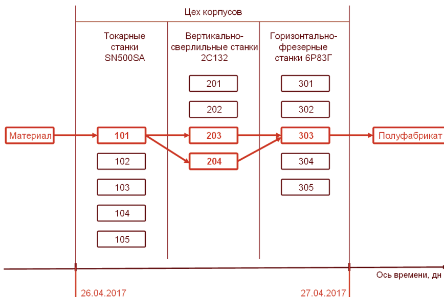
Рис. 5.23. Движение обрабатываемой партии полуфабрикатов на момент выполнения операции фрезерования
