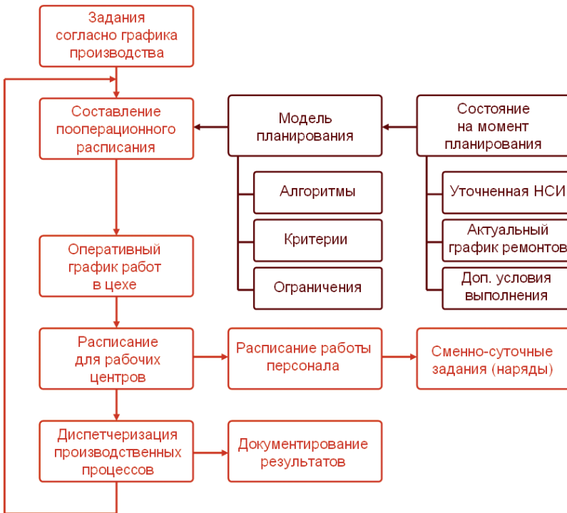
Рис. 5.6. Укрупненная функциональная схема MES-системы
